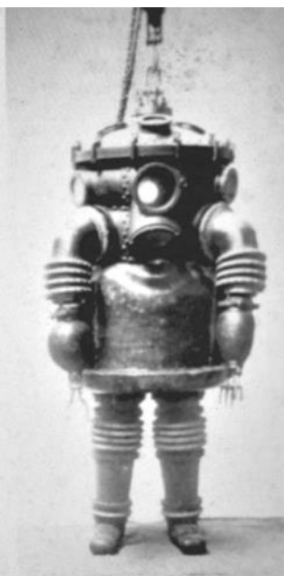
Fig. 11 – ADS Gabanna dotato del sistema di respirazione autonoma con bombole d'ossigeno e sistema di assorbimento dell'anidride carbonica. Le bombole sono applicate all'esterno dello scafandro e ricoperte da un lamierino di protezione (g.c. Letizia Galeazzi).
